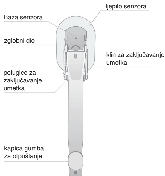
Slika 2. Sklop senzora (senzor i umetka)
