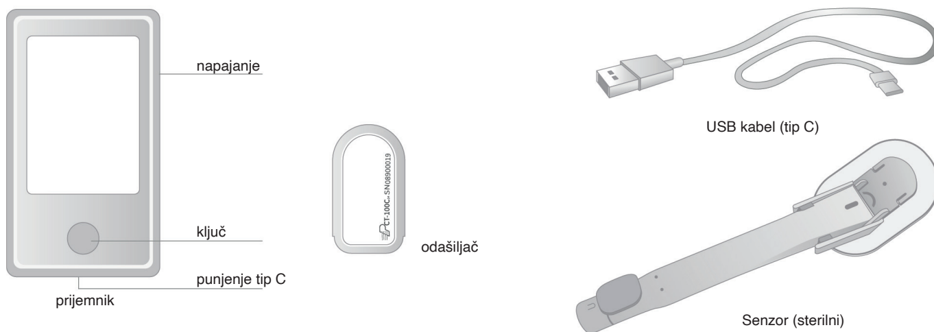
Slika 1. Sustav: senzor, odašiljač, prijemnik
